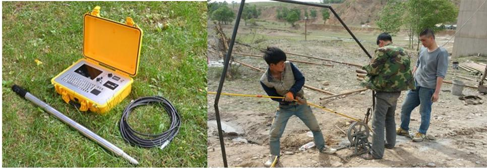
项目概况：由于历史原因，桥梁下分布大量采空区，基于物探结果，沿铁路沿线 8 米间隔布置勘察钻孔，设计钻孔 400 个，采用三维激光扫描测量后，优化布置钻孔 230 个，节省成本约 140 万元，提前工期 2 个月。
